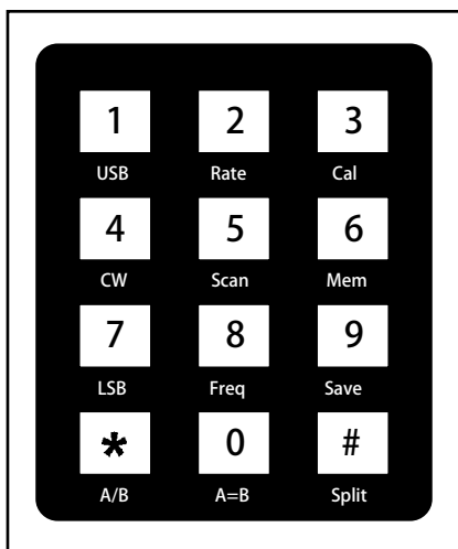
图9. 键盘贴面图(Keypad Overlay for Reproduction), 宽47 mm, 高57.5 mm
