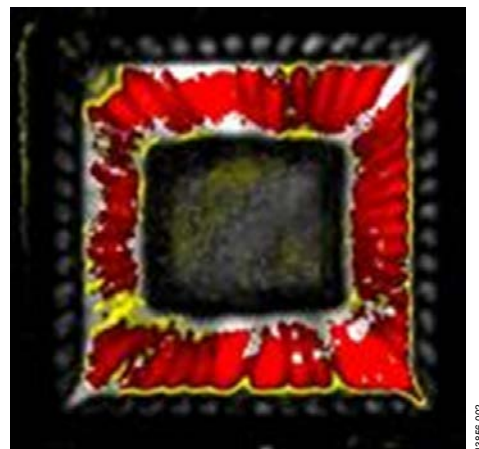
図 2. 不適切な取りはずしによる LFCSP ダイ・パドルの層剥離 (走査型超音波顕微鏡による観察結果)
