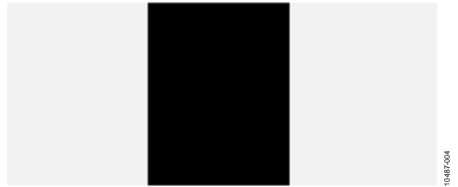
図 4. ADA4830-1 によって 1 V p-p、500 kHz のコモン・モード・ノイズを除去した、黒いストライブのビデオ表示画面
