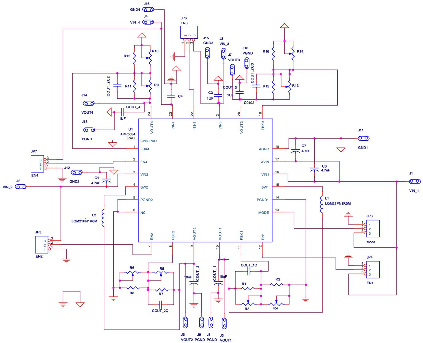
図 9.ADP5034 の評価用ボード回路図
