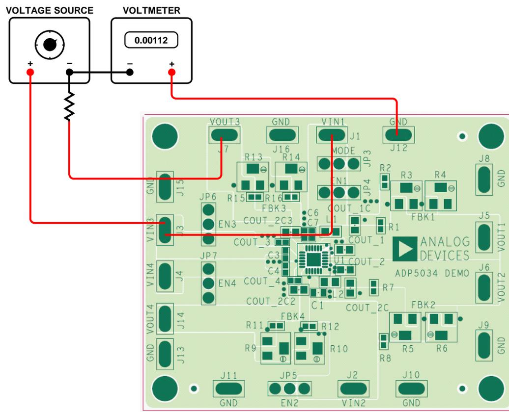
図 8. グラウンド電流の測定
