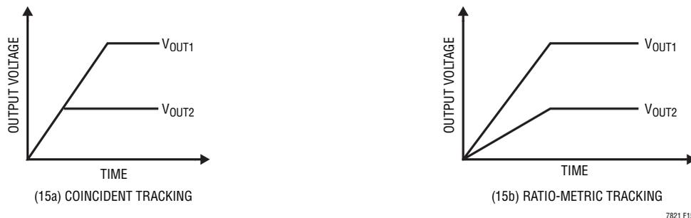
図15. 2つの異なる出力電圧トラッキング手法
