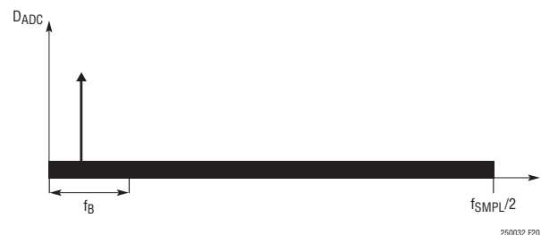
図20. SAR ADCコア出力の周波数スペクトル
