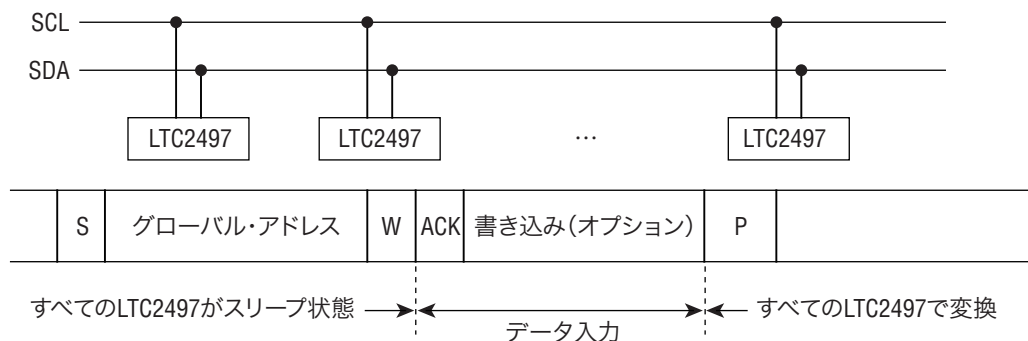
図8. グローバル・アドレス呼び出しによる複数のLTC2497の同期
