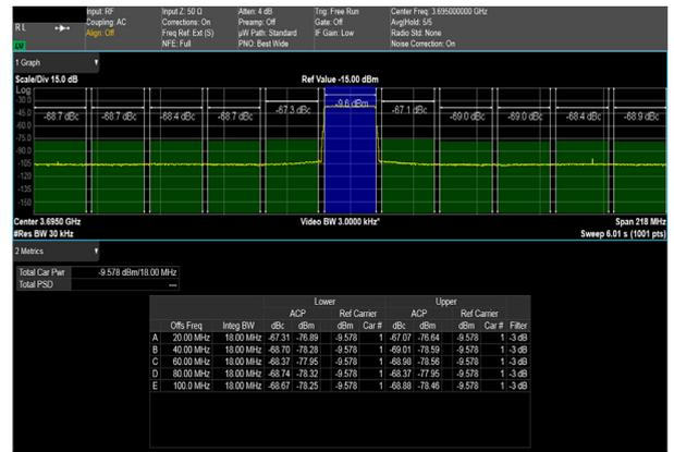
図 36. 3695.0MHz での 20MHz LTE 搬送波 ACLR
