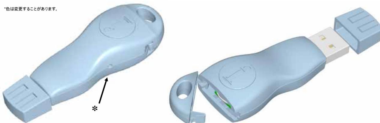
\* 注: iButton を取り出すためには、DS9490B 側面のアクセスホールに真直ぐに伸ばしたペーパークリップを挿入して iButton の方向に押し込んでください。こうすると、別の iButton を挿入することができます。データコンタクト面は、下を向いており、浮き出し文字「i」とは反対側です。DS9490B を USB バスから切り離してからペーパークリップを挿入してください。
