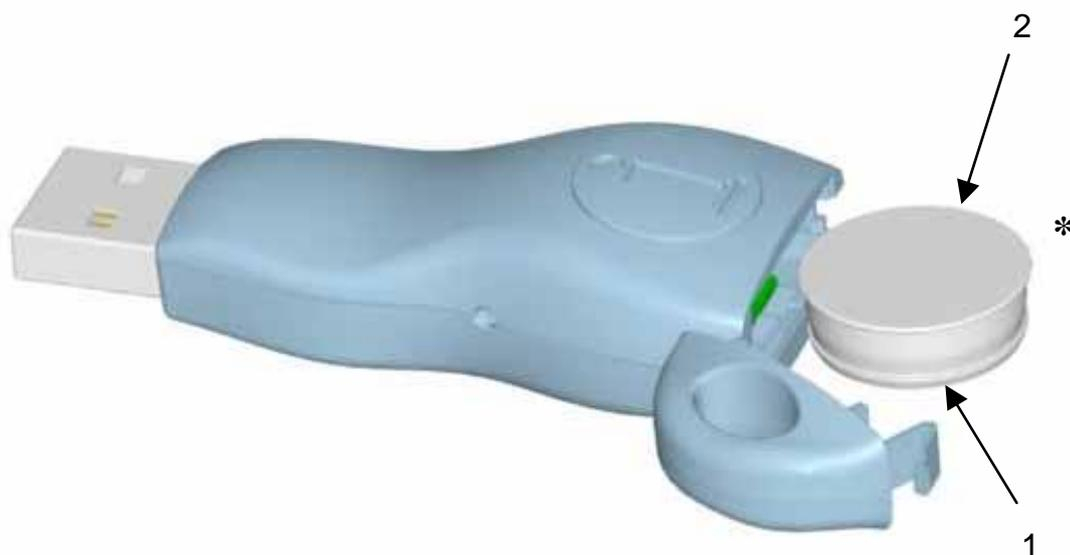
\* 注: データコンタクト面は、下の方向で、浮き出し文字「i」と反対方向を向いています。iButton をエンクロージャに挿入した後は、エンドキャップをパチンと閉めてください。エンドキャップは、リリースタブを押し、これを廻して完全に開き、ヒンジを外側に動かすと取り外すことができます。
