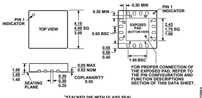
図 27. 16 ピン・リード・フレーム・チップ・スケール・パッケージ [LFCSP\_LQ]
