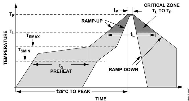
図 25. 推奨するハンダ付けプロファイル
