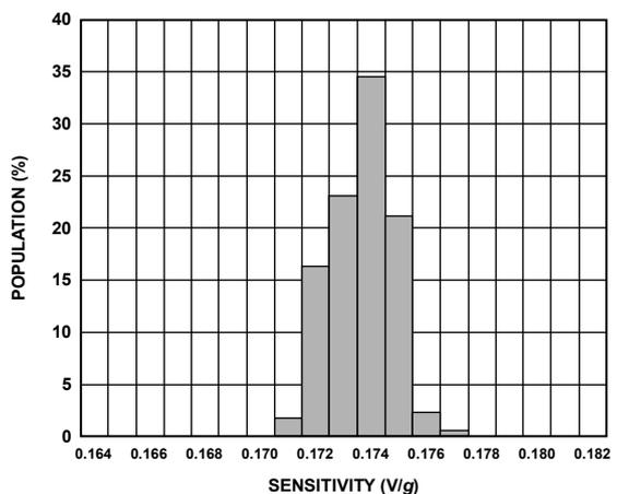
図 16. Y 軸の感度 (25°C、 $V_S = 3\text{ V}$ )
