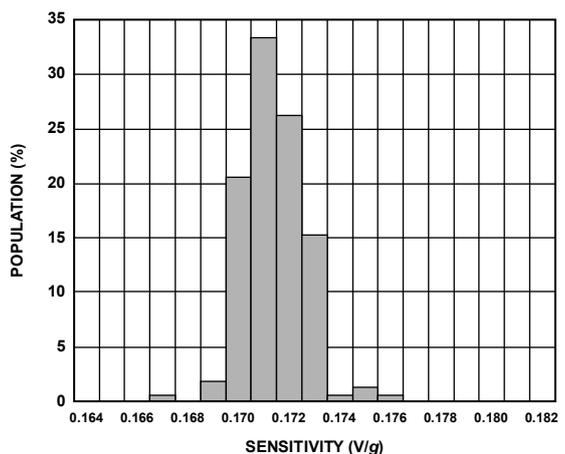
図 17. Z 軸の感度 (25°C、 $V_S = 3\text{ V}$ )
