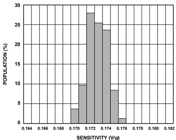
図 15. X 軸の感度 (25°C、 $V_S = 3\text{ V}$ )
