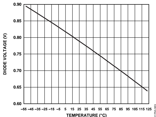
図 48. 温度ダイオード電圧の温度特性
