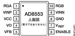
図1. 10ピンMSOP
