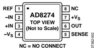
図 3.MSOP のピン配置
