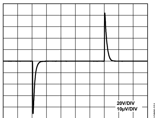
図 31. オペアンプ負荷過渡応答 (100 μA 負荷変化)
