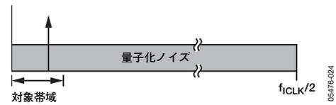
図23.  $\Sigma\Delta$  ADC、量子化ノイズ
