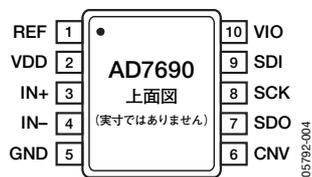
図5. 10ピンMSOPのピン配置
