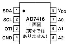
AD7416ピン配置 SOIC/μSOIC
