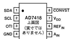
AD7418ピン配置 SOIC/μSOIC
