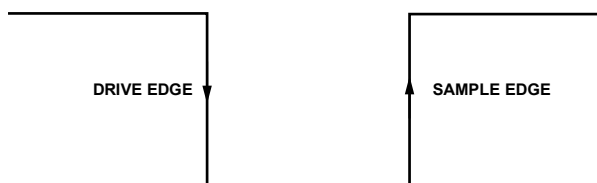
図 25. SPI モード 3 での SCLK エッジ
