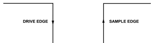
図 65. SPIモード3、SCLKのエッジ
