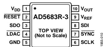
図 10.ピン配置、10ピン MSOP、SDO オプション
