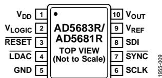
図 9.ピン配置、10ピン MSOP、V<sub>LOGIC</sub> オプション
