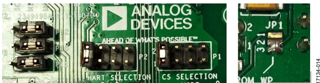
図 12. EVAL-CN0414-ARDZ のデフォルトのジャンパ位置/接続
