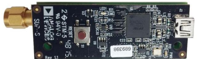
図 16. EVAL-CN0399-SDPZ ボードに接続された SDP-S ボード底面の写真
