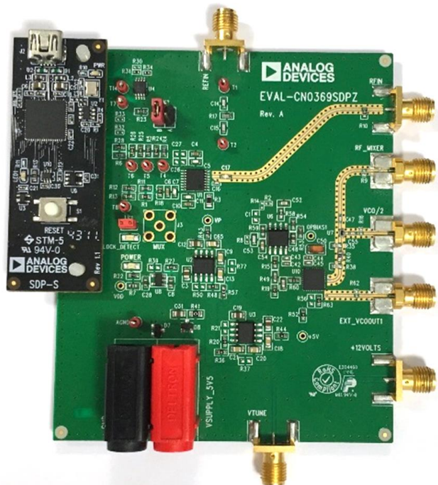
図 10. EVAL-CN0369-SDPZ PCB の写真
