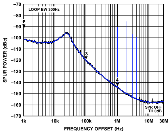
図 3. ADF4153 を使用した時の ADF4350 の位相比較周波数スプリアス (1.6 GHz)
