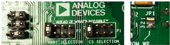
图12. EVAL-CN0414-ARDZ默认跳线位置/连接
