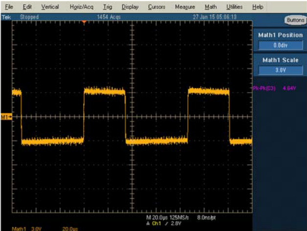
图9. EVAL-CN0373-EB1Z板上RS-485端口的Y-Z数学波形
