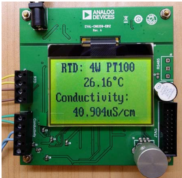
图12. EVAL-CN0359-EB1Z板照片，显示测量模式下的主画面
