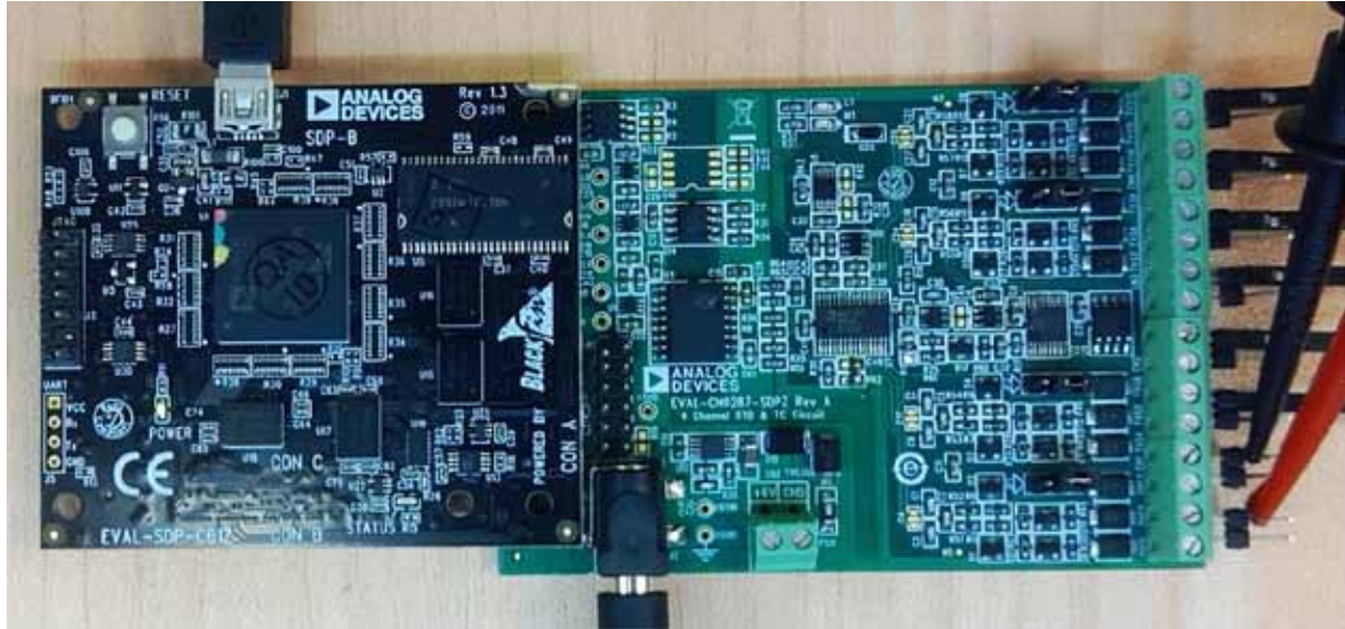
图11. 连接到EVAL-SDP-CB1Z SDP-B板的EVAL-CN0287-SDPZ评估板
