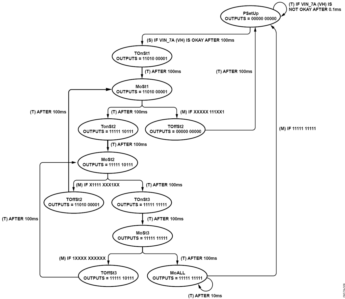
图 8. 电源监控与时序控制策略状态机图
