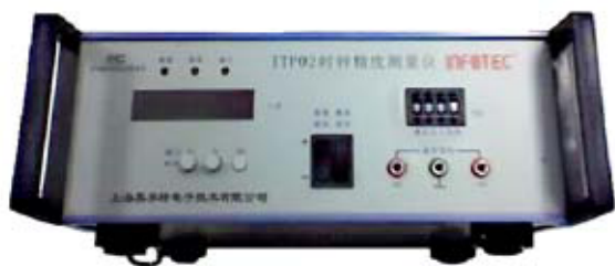
Рис. 2. Эталонные часы реального времени ИТР02 от Infotec
