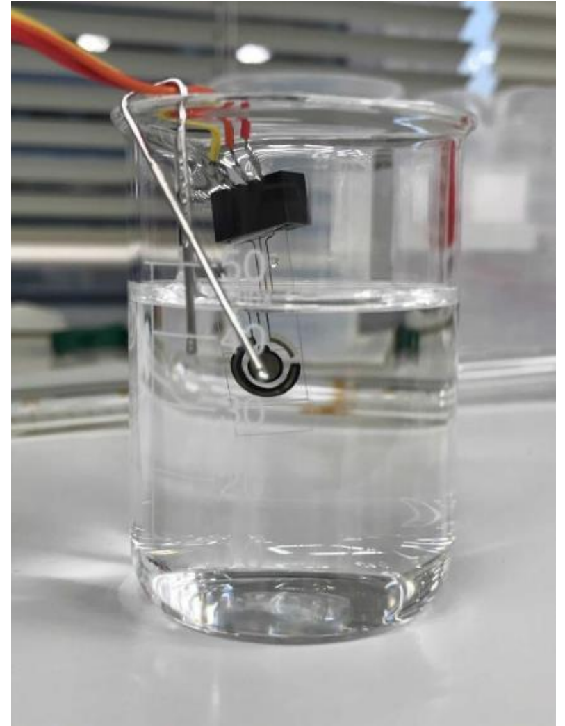
(左図) EmStat PicoをPCと接続して測定 (右図) センサが測定中に動かないように固定
