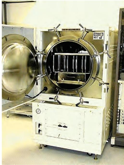
図 11. 標準的な HAST 試験システム
