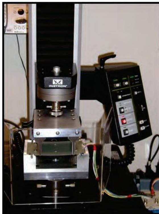
図 93. Instron 4455A 曲げ試験機
