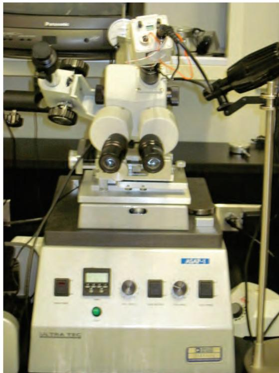
図 119. Ultra Tec 製の背面シンニング装置
