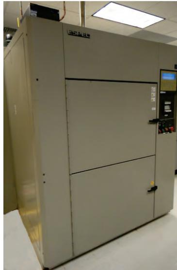
図 12. 標準的な温度サイクル試験チャンバー
