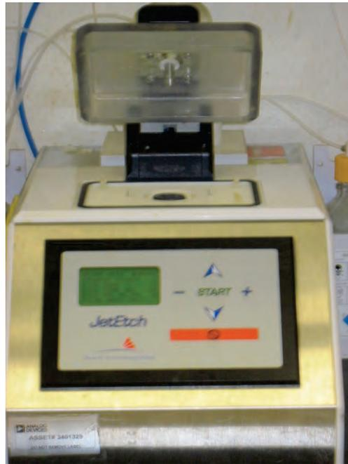
図 118. JetEtch 開封装置
