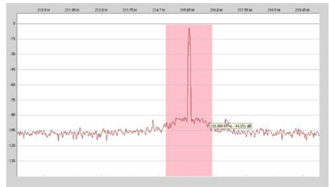
図 7. 785MHz のシングルトーンを入力した場合に、基本波から 1.2MHz の位置に生じるスイッチング・スプリアス (スプリアスのレベルは-94dBFS)
