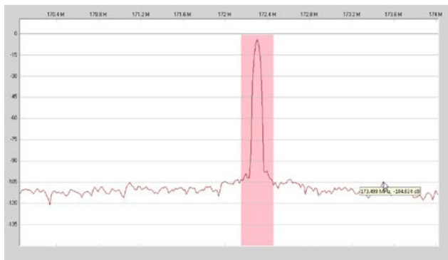
図 6. 170MHz のシングルトーンを入力した場合に、基本波から 1.2MHz の位置に生じるスイッチング・スプリアス (スプリアスのレベルは-105dBFS)
