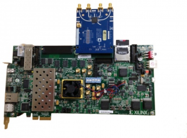
図2：システム開発者は、AD9361 FMC ボードを使用し、Xilinx FPGAによりSDRアプリケーションの開発、デバッグ、評価、調整を行うことができ、ハードウェアのセットアップは最小で済みます。
