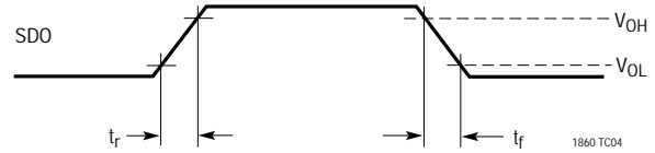
SDOの立上り時間 t_r と立下り時間 t_f の電圧波形
