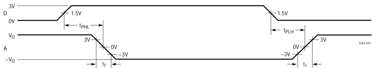
図7. V.10、V.28 ドライバ伝搬遅延
