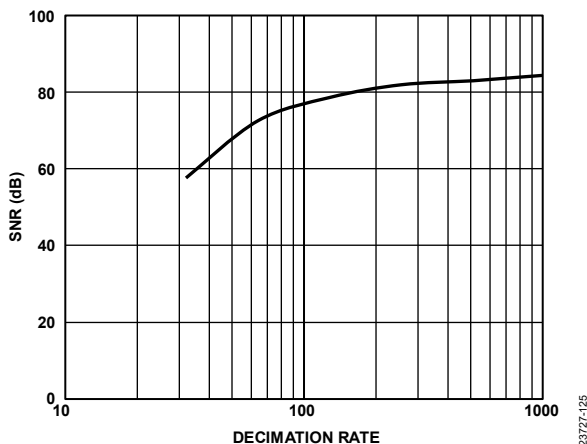
図 31. sinc3 フィルタの S/N 比とデシメーション・レートの関係
