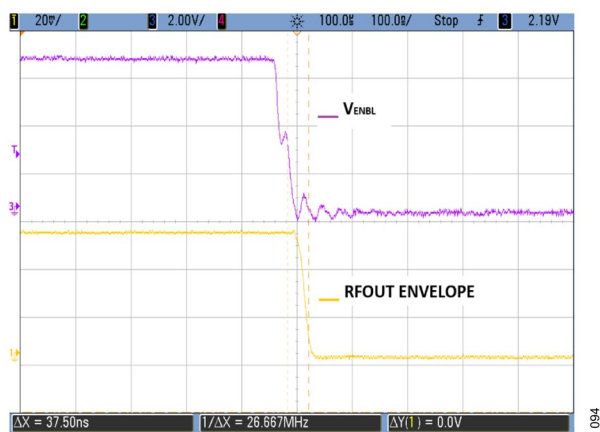
図 94. VENBL ピンがトグルしたときの RFOUT エンベロープのオフ応答のタイミング
