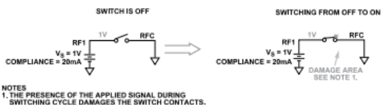
図 63. スイッチがオフ状態からオン状態に切り替わる際のホット・スイッチング状態
