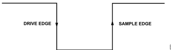
図 61. SPI モード 3、SCLK のエッジ
