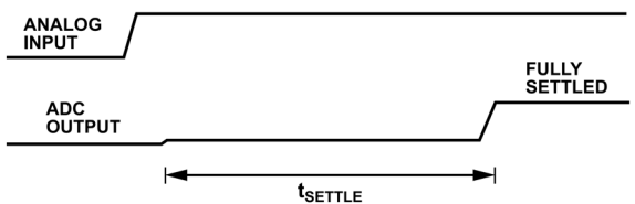
図 27. シングルサイクル・セトリングでのステップ入力
