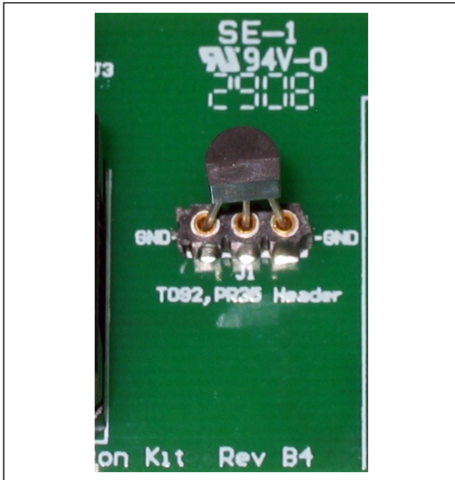
図3. TO92/PR35パッケージの挿入
