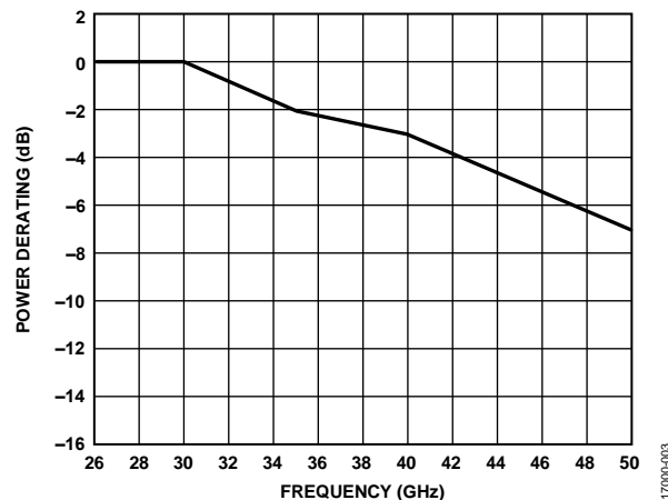
図 3. パワー・ディレーティングと周波数の関係、高周波数の詳細、 T_{CASE} = 85^{\circ}C
