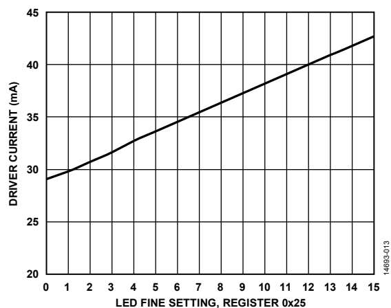
図 13. LED ドライバ電流と LED 微調整の関係 (おおまかな設定 = 0x0)
