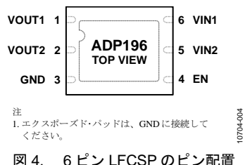
図 4. 6 ピン LFCSP のピン配置
