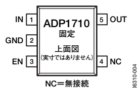
図4. 5ピンTSOT (UJの末尾記号)
