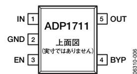
図6. 5ピンTSOT (UJの末尾記号)
