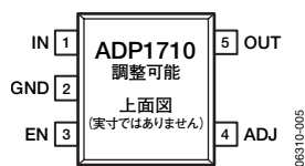
図5. 5ピンTSOT (UJの末尾記号)
