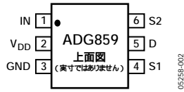
図2. 6ピンSOT-66のピン配置
