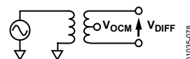
図80.二次側低出力インピーダンスを V_{OCM} に設定したトランス
