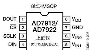
図8. 8ピンMSOPのピン配置
