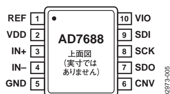
図5. 10ピンMSOPのピン配置
